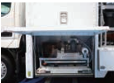
(写真上) 固体(汚物)をフィルターで分離する引出式固液分離装置 / (写真下) 折畳み昇降ステップ
